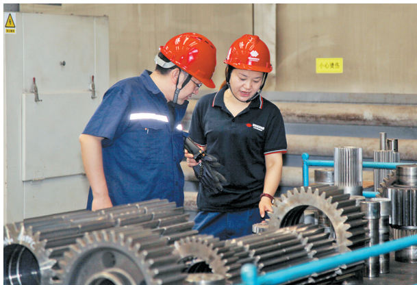
神东煤炭设备维修中心坚持“零故障、高品质”目标,全面排查整治井下重点部件安全隐患,严格落实互检专修、联防联控工作机制,切实筑牢检修安全屏障。图为9月7日,维修二部职工检查刮煤机齿轮箱故障点。
