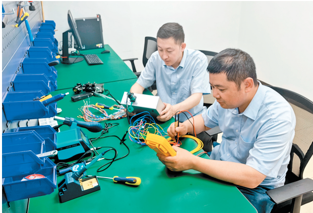
QC小组成员调试快捷式铁路信号机智能检测仪。
