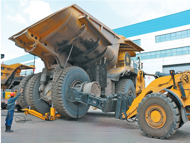
检修人员拆卸重型卡车车轮。
