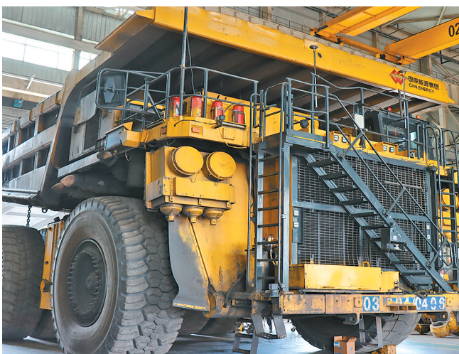
经改进修复的 830E 卡车电动轮安装到重型卡车上投入试用。
