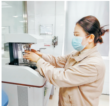
大图:安徽铜陵电厂东湖光伏电站航拍图。 小图:化验人员用激光量热仪对煤样进行热量测试。
