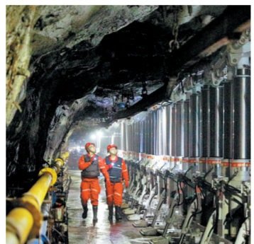
大图 无人驾驶矿卡在准东露天矿场有序运行。 小图 乌东矿职工在工作面检查液压支架。
