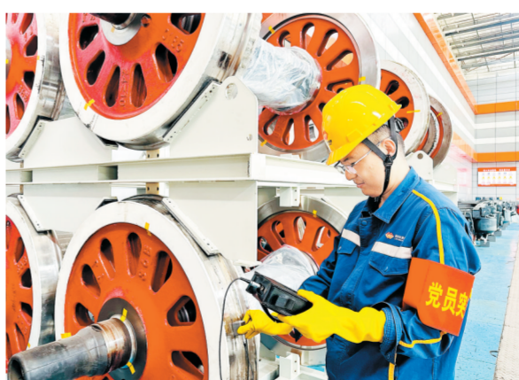
↑7月3日，包神铁路机务分公司东胜检修设备车间“党员突击队”队员检查轮对踏面磨耗情况。
