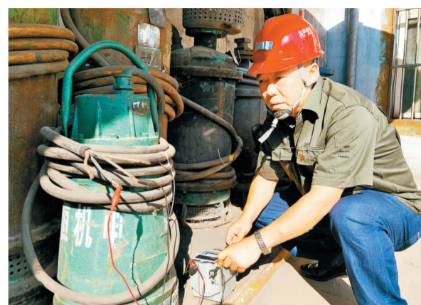
庄永顺测试潜水泵绝缘阻值。
