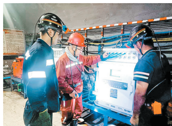
李克平(中)与检修人员检查胶带输送机控制系统运行情况。
