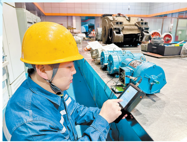
小组成员收集电机轴承运行参数。
