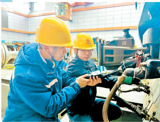
小组成员试验“管路泄漏智能检测装置”。
