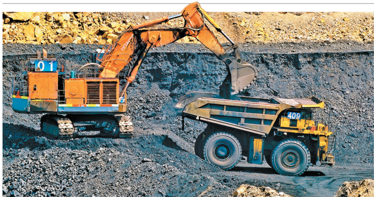
今年以来,准能黑岱沟露天煤矿通过优化运煤通道、实施扩帮内排与交替开采等措施,全力保障煤炭稳产。同时,聚焦电铲有效作业时间,推动“铲先动、车配合”,打破“车等铲”困局,贯通穿爆、采掘、运输等五大环节协同作业,减少外部干扰时间,提升整体生产效率。截至5月25日,该矿年累计生产商品煤1258.8万吨。图为液压反铲配合卡车进行装煤作业(摄于5月25日)。
