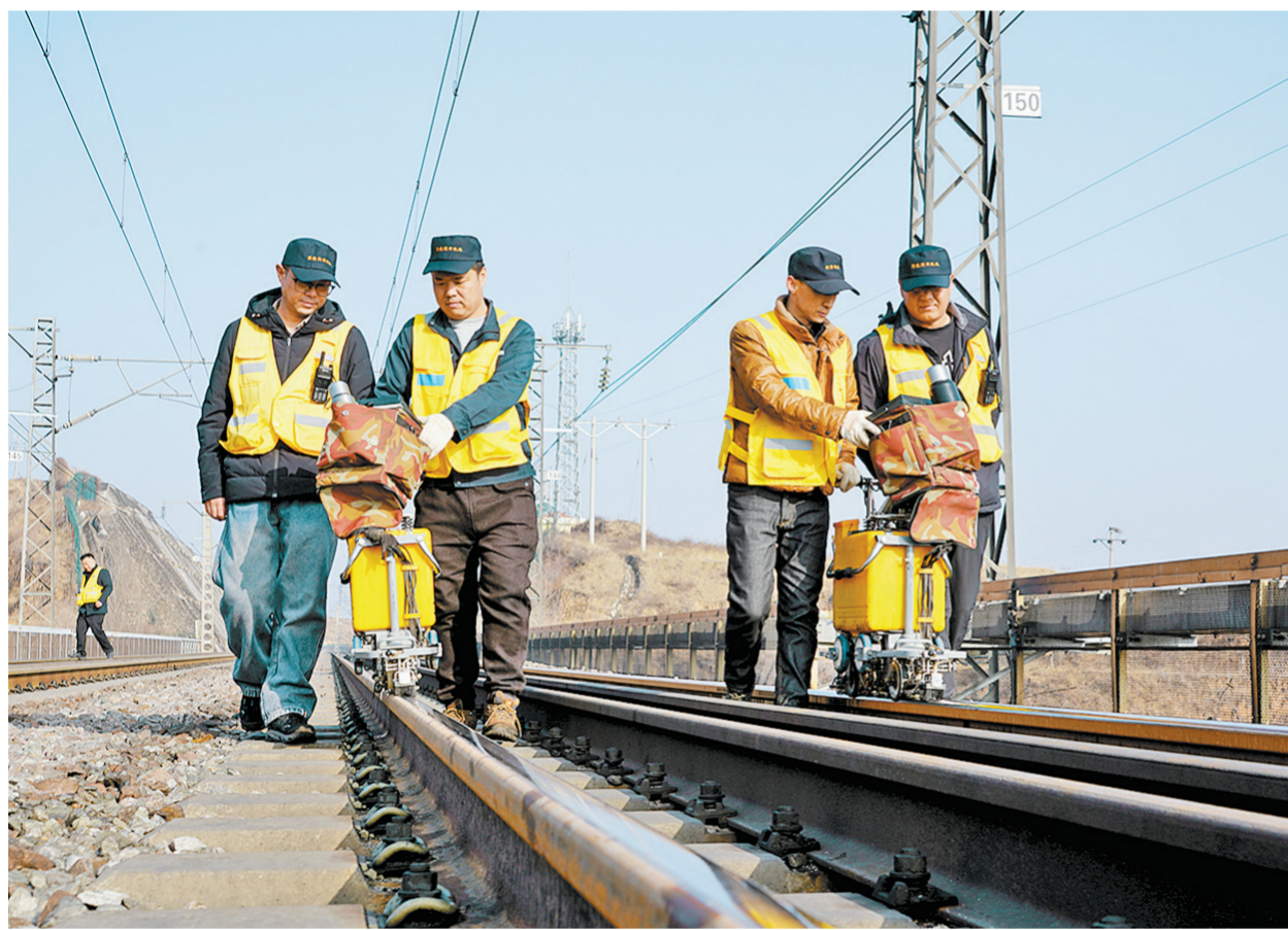
↑春夏交替时节,钢轨易受温差影响产生伤损。朔黄铁路原平分公司钢轨探伤工利用天窗时间,加密道岔、焊缝、母材等关键部位的探伤频次,精准排查每一处潜在隐患,全力守护能源大动脉运输畅通。图为5月16日,探伤工在原平南站至北大区间进行钢轨探伤作业。 本报特约记者 任振华 摄
