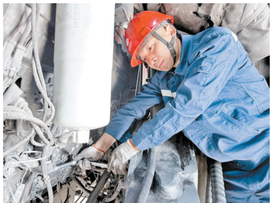
王涛拆卸高压燃油泵固定螺栓。
