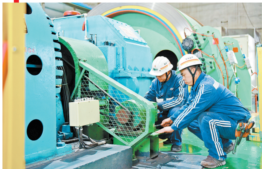
⑤ 5月2日,平庄煤业六家矿检修工点检主井提升绞车减速机。 本报通讯员 郭浩 摄
