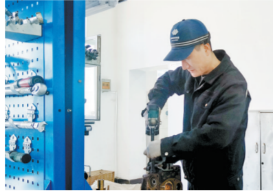
→作业人员组装检修后的制动阀。
