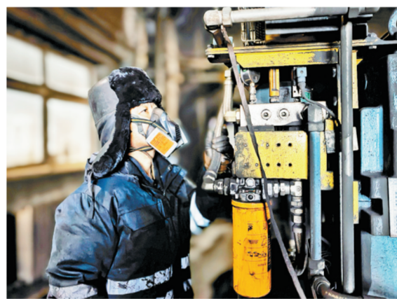
↑近日,雁宝能源运销公司全面开展设备检修工作,对润滑保养、阀门灵活性等进行全面细致排查,做到检查细致无遗漏、维修及时不拖延,以良好设备运行状态筑牢安全生产防线。图为4月10日,维修钳工检查装车胶带减速机循环油泵泵是否异常。 本报通讯员 王坤 摄
